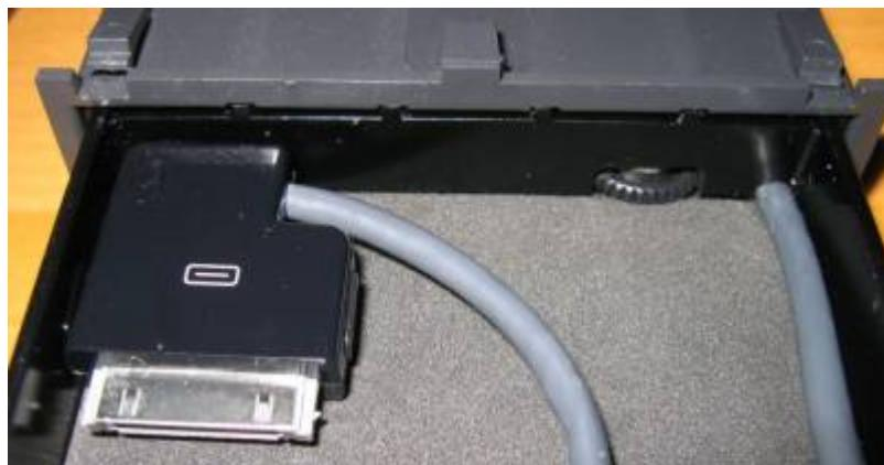
Die Kabel nun mit Schrumpfschlauch ummanteln und anlöten. IPOD dran und los gehts zum ersten
