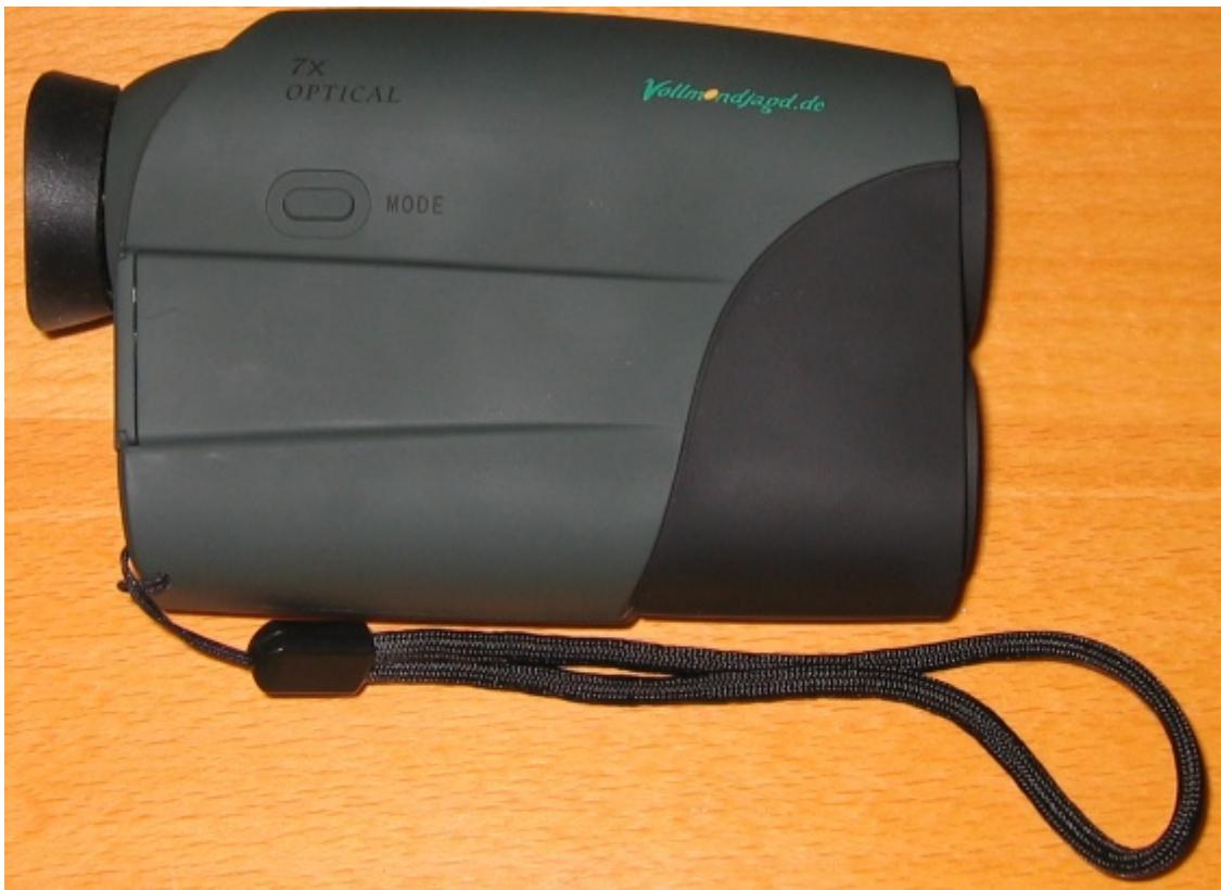
Frontansicht : Man erkennt die obere Linse wo das Auge das Objekt sieht und wo der Laserstrahl ausgesendet wird. Die Untere Linse ist mit der Empfängeroptik verbunden (vermutlich ne APD Diode).
