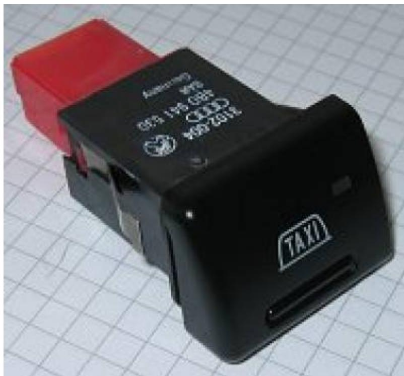
Mit dem Schraubendreher den Deckel des Tasters abhebeln und das kleine Plexiglasstück in der Mitte herausziehen
