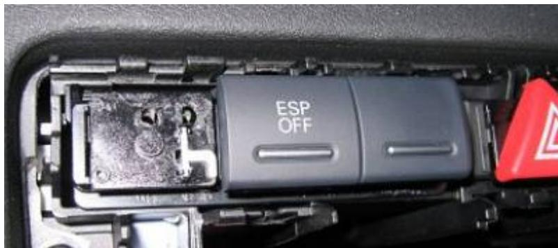
Wenn man jetzt den Deckel probehalber aufsetzt merkt man gleich, das dieser zu dicht an den ESP OFF Taster anstößt. Dies umgeht man, in dem man (hier beim linken Taster) die rechte Seite etwas kürzt.
