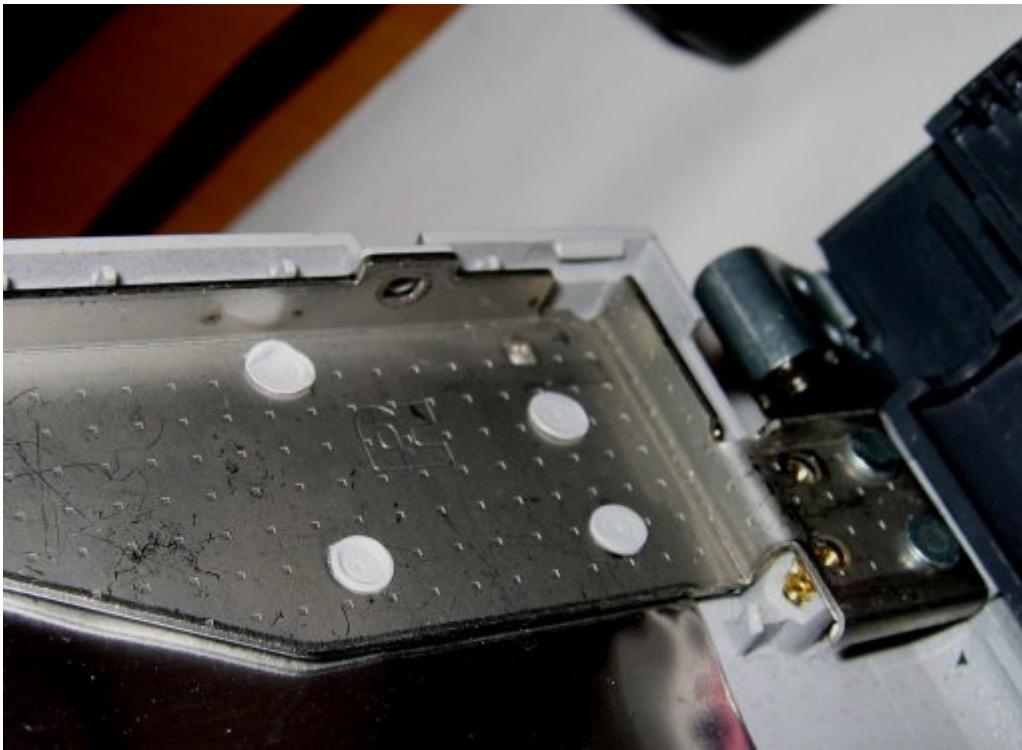
Nun mit einem scharfen Messer die weissen Plastiknasen plan mit der Oberfläche des Metall-Scharniers abtrennen.
