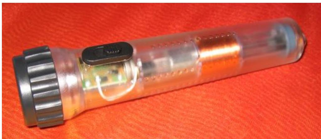
Durch das halbdurchsichtige Plexiglas sieht man rechts vom Schalter 2 Zellen. Sollten das die Energie-Speicher sein ? Auf der Rückseite der Platine ist jedenfalls noch ein Goldcap ... Da die Lampe den Öffnungsversuchen standhielt, musste die Säge ran. Vorne am Gewinde einen Millimeter absägen und schon kann man das Innere der Lampe herausziehen.
