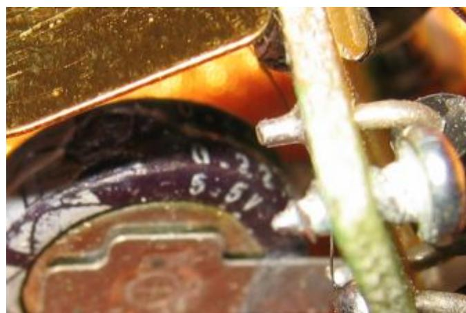
Ein ELNA Goldcap mit 0,22F und 5,5V Spannung. Das wäre dann für die Zeit nach dem Leersaugen der Lithiumzellen der Energiespeicher. Ob die leeren Zellen dann hochohmig werden oder die Funktion der Lampe ganz dahin ist - wir werden sehen.
