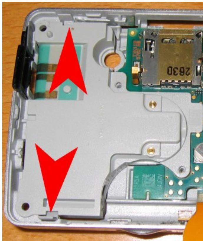
13. Platine herausnehmen. Auf der Unterseite ist der SIM-Karten Halter. Vorsichtig alle 6 Kontaktfedern wieder etwas weiter nach oben biegen so das diese mehr Kraft auf die SIM-Karte ausüben.
