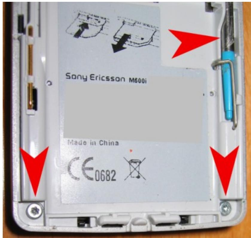
2. Mit einem spitzen Gegenstand die Abdeckung der Antennenbuchse herausholen sowie SIM-Karte, Speicherkarte und die TORX-Schraube unten rechts herausdrehen :
