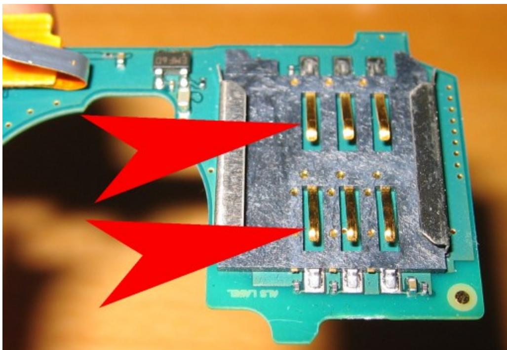
Damit wäre die Kontaktschwäche erst mal behoben. Nach dem Zusammenbau in umgekehrter Reihenfolge musste nur die Uhr neu eingestellt werden, ansonsten waren bei mir alle Daten weiterhin vorhanden.
