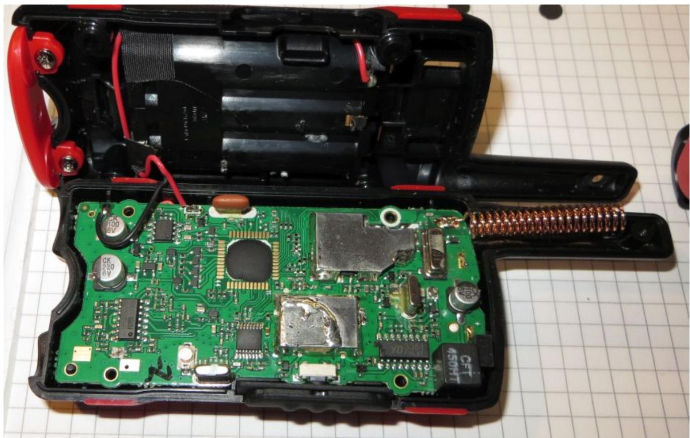
Nach einem rumprobieren findet man schnell das die Batteriespannung HF-geblockt an einen hochohmigen Spannungsteiler gegeben wird aus  $2 \times 100\text{k}\Omega$  und die heruntergeteilte Spannung dann an den Microcontroller geht. Dieser entscheidet dann ob Low Batt ist oder nicht ...
