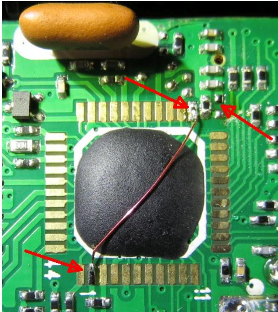
Der Umbau ist leicht gemacht : R1 vom Spannungsteiler entlöten (das ist die zuführung der Batteriespannung), Einen Draht von Pin 2 auf Pin 23 ziehen - damit liegt immer 2,83V am ADC Eingang an und er erkennt immer „Full Batt“. Das Symbol „Low Batt“ taucht nicht mehr auf bis das Gerät seine Funktion einstellt.
