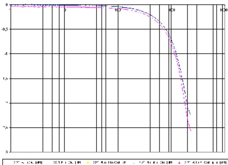
Auf 435MHz beträgt die Durchgangsdämpfung nur 0.22dB ... 0.27dB. Die 0.2dB liegen bei ca. 300 MHz. Fürs 2 Meter Band stimmen die Angaben also schon mal.
