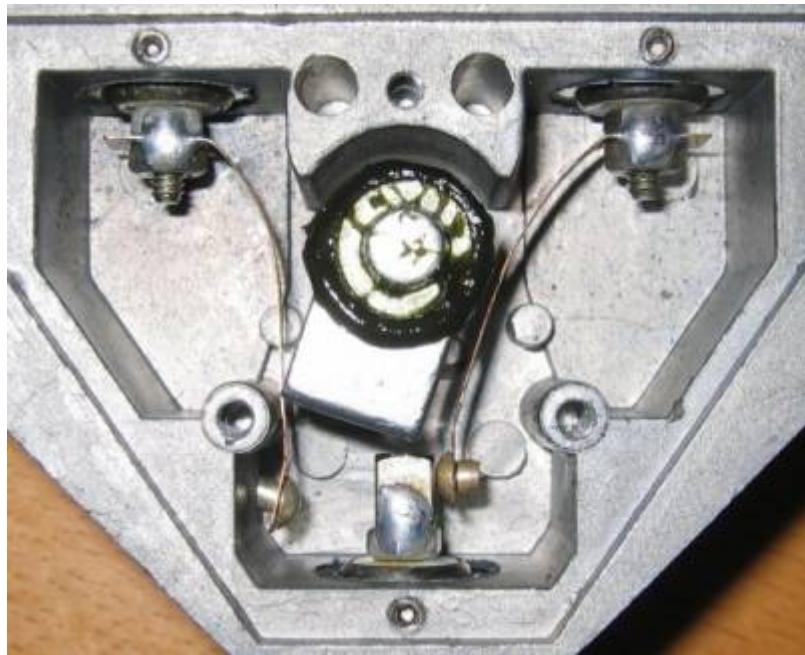
Der Durchgeschaltete Eingang liegt per Kontakt auf dem Ausgang, der nicht benutzte Eingang wird durch den Block in der Mitte nach Masse geschaltet. Einfaches aber gutes Prinzip.
