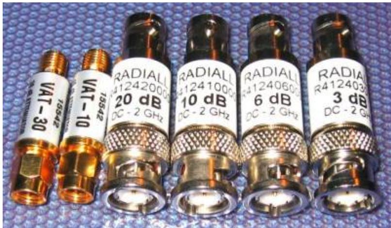
Zum Einsatz kommen 2 SMA-Dämpfungsglieder von Minicircuits (10 & 30dB), sowie 4 BNC-Dämpfungsglieder von Radiall (3 & 6 & 10 & 20dB).
