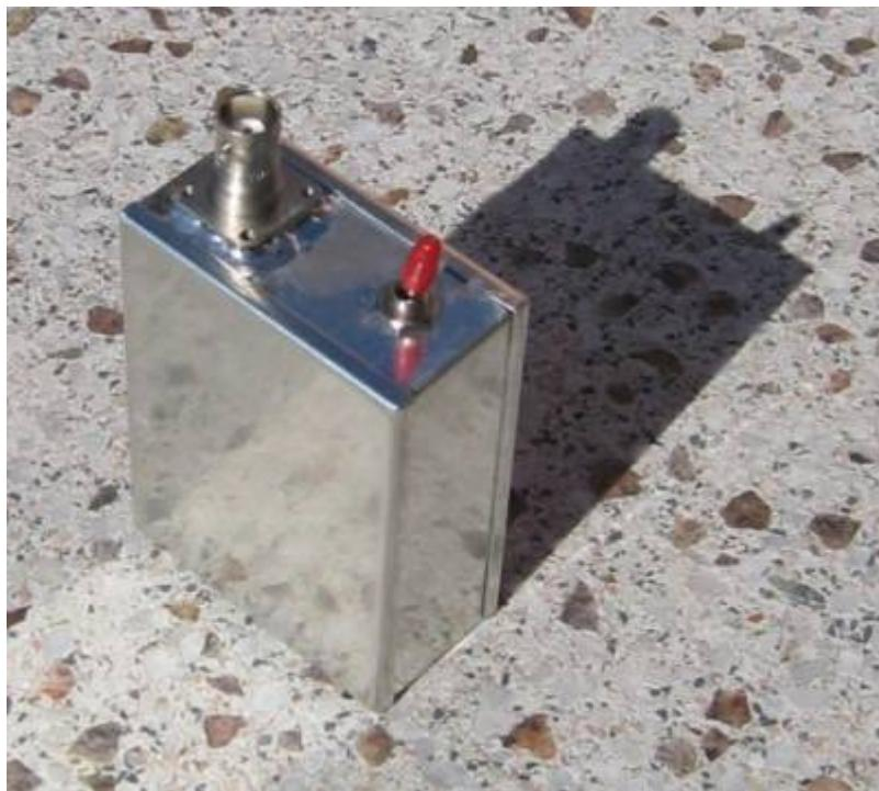
Das Prinzip ist simpel. Durch den Quarz-Oszillator gelangen die 4MHz auf einen Binär-Teiler. Mit diesem lassen sich die unterschiedlichen Teilerfaktoren einstellen, welche dann den Frequenz-Abstand der Nadeln im Spektrum bestimmen. Damit die Schaltung lange läuft wurde der Stromverbrauch minimiert und ein Low-Drop Regler verwendet.
