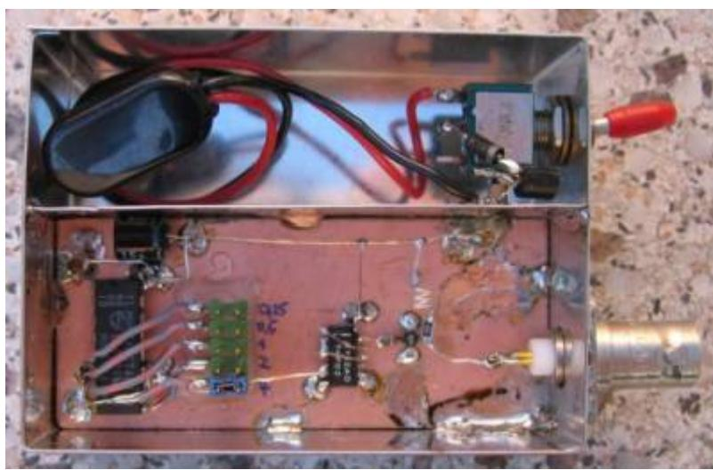
Teil 1 : Oszillator mit TTL-Out sowie Teiler für Wiederholraten von 4/2/1/0,5/0,25 MHz :
