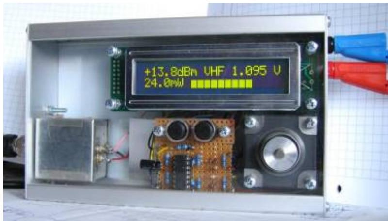
Die eigentliche Schaltung habe ich noch um einen Steppermotor erweitert, der als Drehimpulsgeber funktioniert. Damit lassen sich die Menüs komfortabel durchscrollen. Auf der linken Seite im Gehäuse sieht man eine kleine Weissblechschachtel in der der eigentliche Leistungsmesser aus 50 Ohm Abschluss und AD8307 sitzt. Dieser misst die Entstehende Spannung, logarithmiert diese gibt das Ergebnis wieder als Spannung aus:
