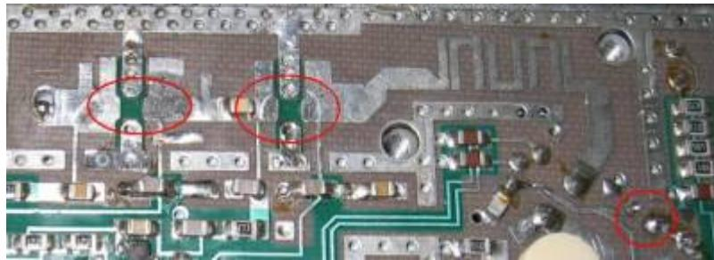
Im Horizontal-Teil werden die beiden Transistoren ausgelötet und verkehrt herum wieder eingelötet. Die Gate und Drain-Spannungen welche von oben kommen, müssen gekappt und auch getauscht werden (Ersatz durch kleine Drahtbrücken). Zum Schluss wird hier auch noch der Auskoppel-C entfernt, das Bandpass-Filter weggekratzt und mit einem Stück leitfähigem Klebebands überbrückt :
